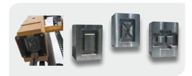
**PLATTEN** - Platten aus besonders widerstandsfähigem Material mit Fräsung der Pfahlprofile
