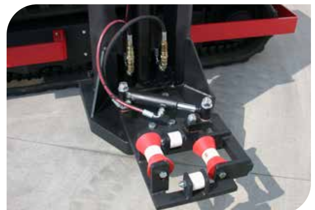
HYDRAULISCH BETÄTIGTE UNTERE FÜHRUNG MIT KUNSTSTOFFROLLEN FÜR DEN ERHALT DER OBERFLÄCHEN DER HOLZPROFILE (Zubehör)
