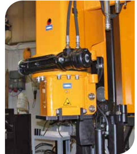
ROTIERENDES HAMMERMAUL ZUM AUSRICHTEN VON VIERKANTPFÄHLEN (Zubehör)
