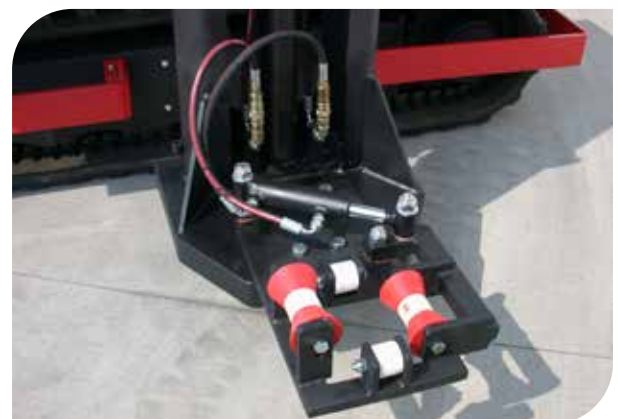
GUÍA INFERIOR DE ACCIONAMIENTO HIDRÁULICO CON RODILLOS EN PLÁSTICO CUYO OBJETIVO ES PRESERVAR LAS SUPERFICIES DE LOS PERFILES DE MADERA (accesorio)
