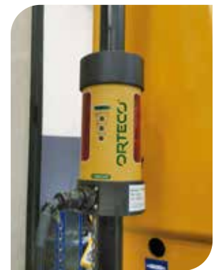
BOUCHE DE MARTEAU ROTATIVE POUR L'ORIENTATION DES PIEUX D'ANGLE CARRÉS (accessoire)
