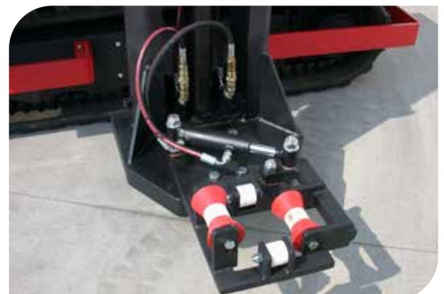
**GUIDA INFERIORE AD AZIONAMENTO IDRAULICO CON RULLI IN PLASTICA PER PRESERVARE LE SUPERFICI DEI PROFILI IN LEGNO** (accessorio)
